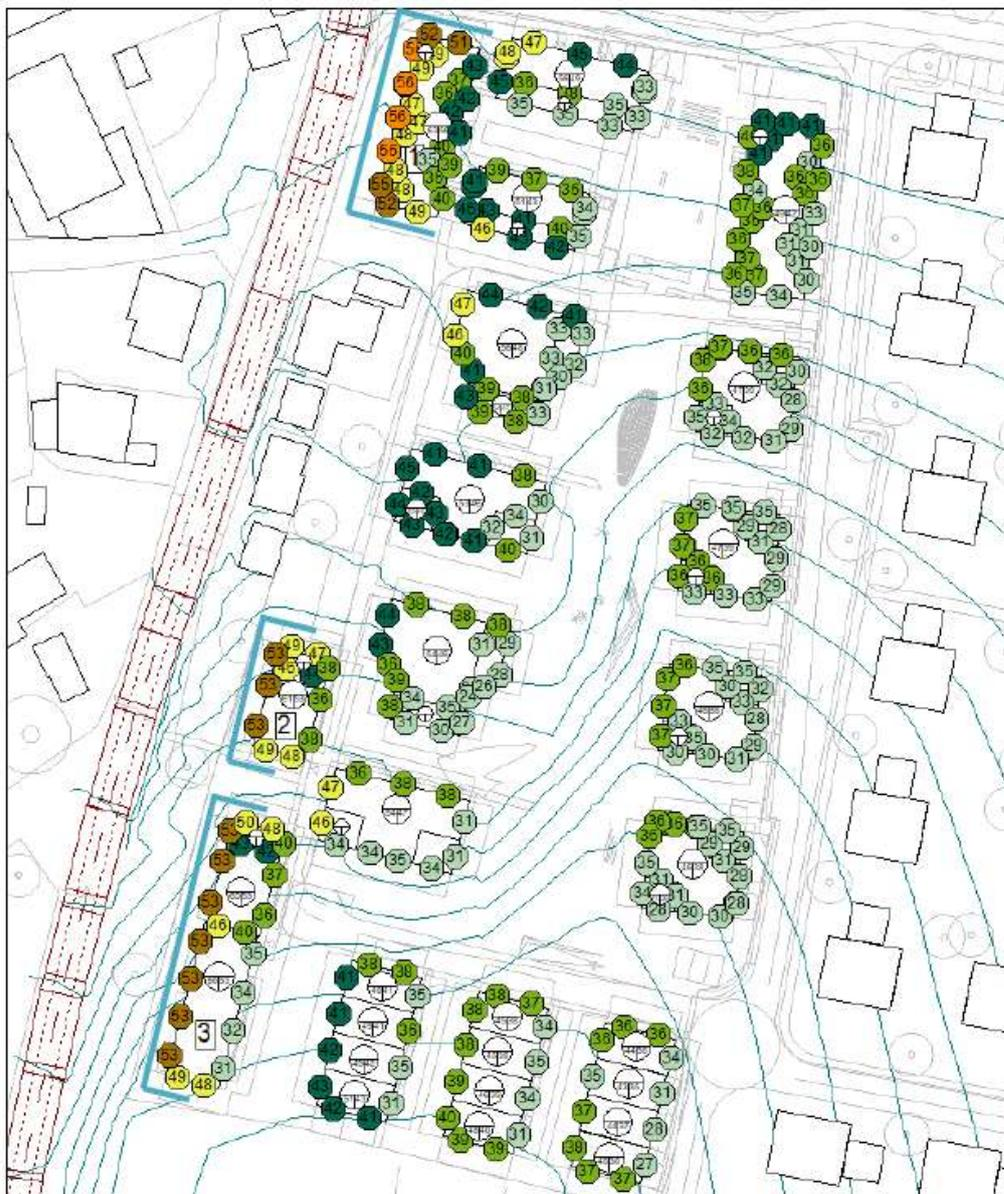
Abbildung 4: Fassaden mit Überschreitung des Lüftungskriteriums
