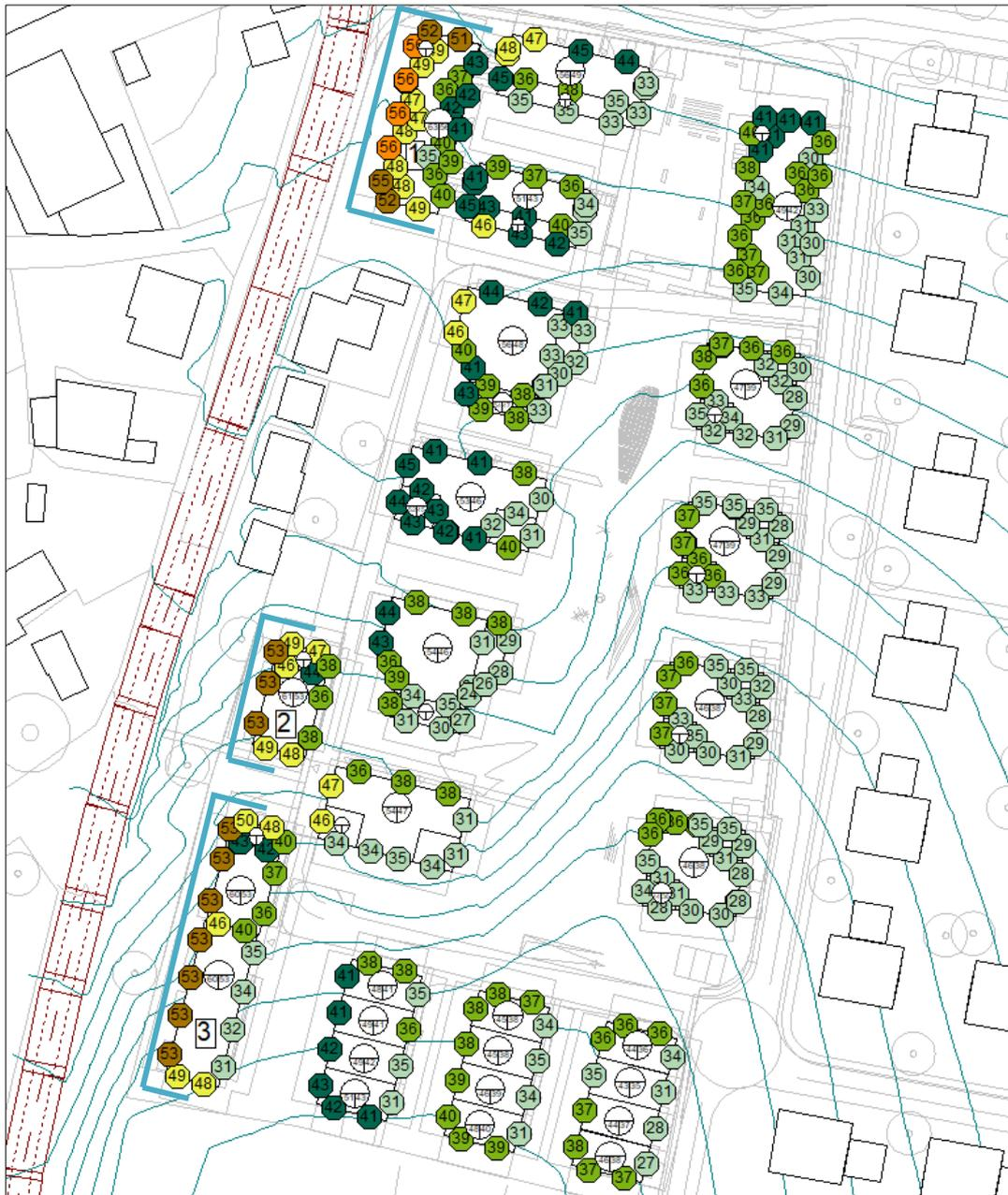
Abbildung 4: Fassaden mit Überschreitung des Lüftungskriteriums
