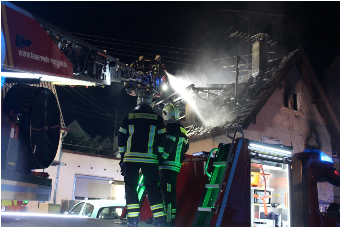
Nachlöscharbeiten am ausgebrannten Dachstuhl durch die Korbbesatzung der Drehleiter
