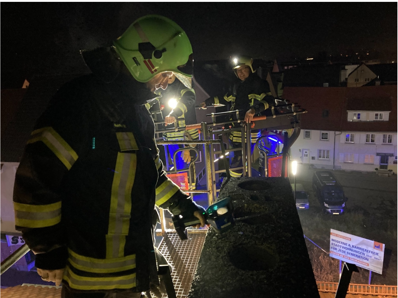
Prüfung der Kaminzüge mittels Wärmebildkamera
