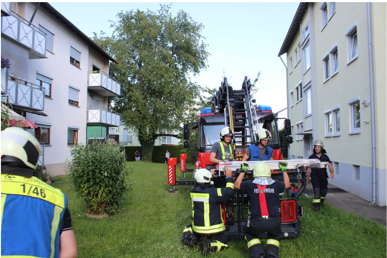
Anbringung der Halterung der Schleifkorbtrage am Korb der Drehleiter
