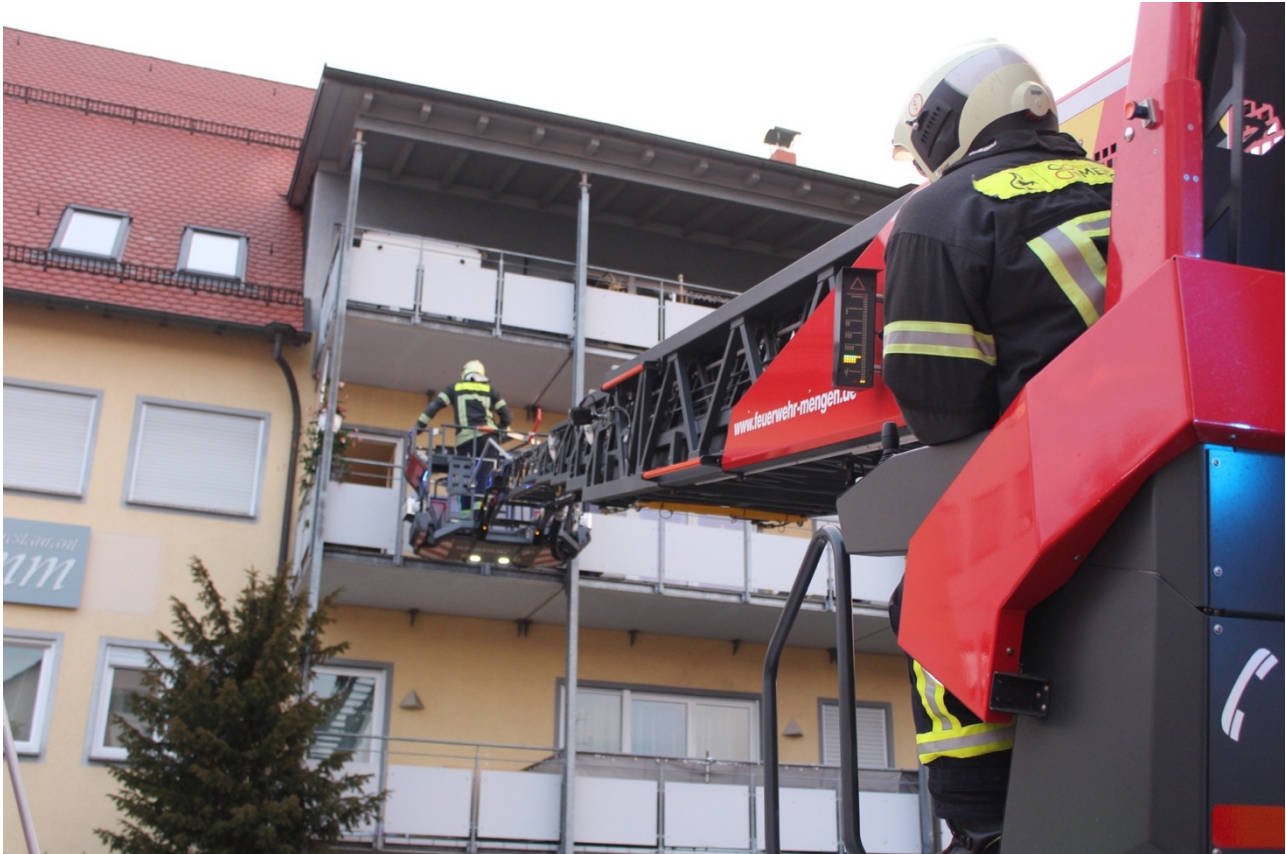
Der Maschinist der Drehleiter überwacht den Anleitervorgang vom Bedienstand auf dem Drehkranz
